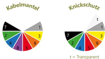
Die Artikelnummer setzt sich aus Informationen zur Farbe des Kabelmantels, des Knickschutzes und der Kabellänge zusammen. --- steht für die Kabellänge in Dezimetern. Ein Kabel mit der Länge 0,5m erhält die Endung 005. Weitere Kombinationen von Kabel- und Knickschutzfarben sind auf Anfrage erhältlich.
