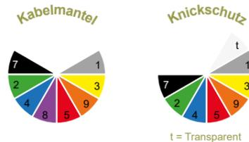
Die Artikelnummer setzt sich aus Informationen zur Farbe des Kabelmantels, des Knickschutzes und der Kabellänge zusammen.
