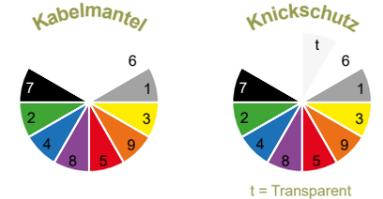
Die Artikelnummer setzt sich aus Informationen zur Farbe des Kabelmantels, des Knickschutzes und der Kabellänge zusammen. --- steht für die Kabellänge in Dezimetern. Ein Kabel mit der Länge 0,5m erhält die Endung 005. Weitere Kombinationen von Kabel- und Knickschutzfarben sind auf Anfrage erhältlich.
